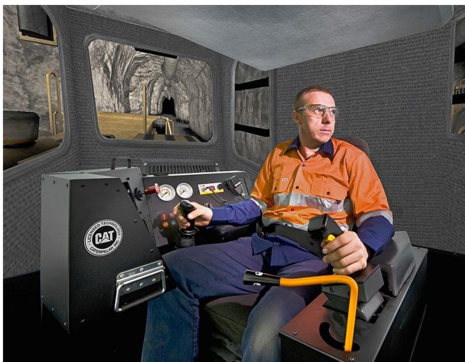
Рис. 1. Работа на симуляторе подземного погрузчика [1]
