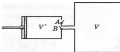
Эту задачу можно решить, используя закон Бойля — Мариотта, хотя в процессе откачки масса газа в сосуде изменяется. Действительно, рассмотрим первый ход поршня влево; при этом клапан  $A$  закрыт, клапан  $B$  открыт, и газ из сосуда входит в камеру насоса. Давление газа уменьшается от первоначального до некоторого  $p_1$ . Поскольку процесс изотермический и масса газа при этом не меняется, можно воспользоваться законом Бойля — Мариотта
