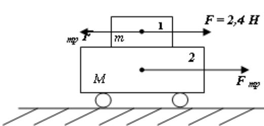
На гладкой поверхности находится тележка массой  $M = 4 \text{ кг}$ . На ней — тело массой  $m = 2 \text{ кг}$ . К телу приложена сила  $F = 2,4 \text{ Н}$ . Коэффициент трения между тележкой и телом  $k = 0,1$ . Определить ускорение тележки и находящегося на ней тела.
