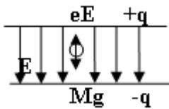
Пусть площадь пластины плоского воздушного конденсатора  $1 \text{ м}^2$ . Каким должен быть заряд на пластинах этого конденсатора, чтобы электрон, помещённый в пространство между пластинами, находился в равновесии?
