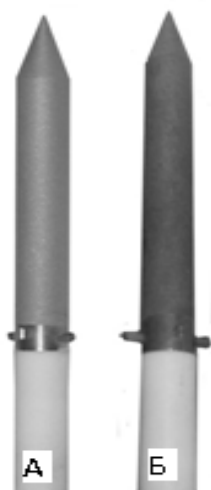
Рис. 1. Экодатчик ОРТЕС-ЕD-1: А — до экспозиции; Б — после 120-дневной экспозиции в Некрополе XVIII века Музея городской скульптуры
