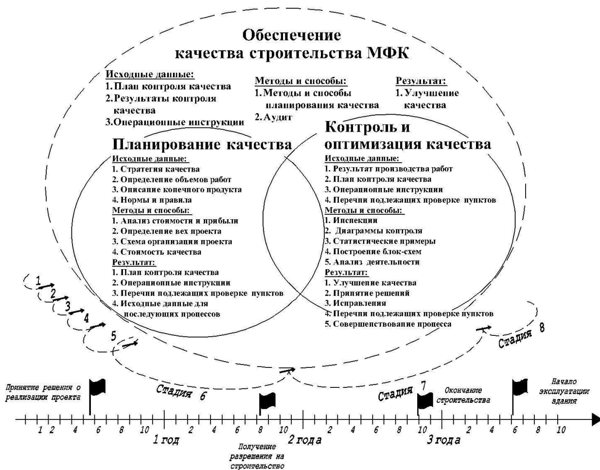
Рис. 4. Модель процесса управления качеством при строительстве МФК
