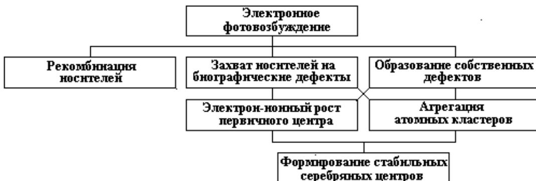
Рис. 2. Схемы релаксации электронного фотовозбуждения в галогенидах серебра
