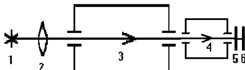
Рис. 1. Оптическая схема установки для определения квантового выхода люминесценции: 1 — лампа накаливания, 2 — фокусирующая линза, 3 — монохроматор, 4 — приставка диффузного отражения, 5 — светофильтр, 6 — фотокатод ФЭУ
