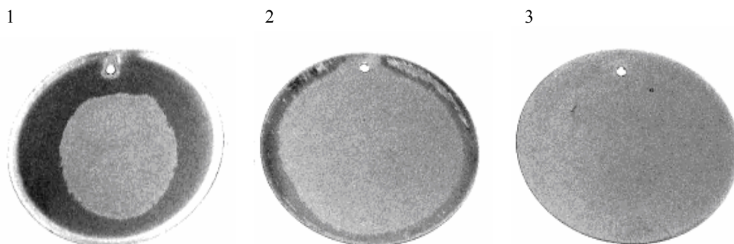
Рис. 1. Фотографии покрытий, соответствующих разной толщине единичного слоя: 1 — 7,7 нм; 2 — 4,7 нм; 3 — 2,9 нм
